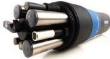
תמונה 2: דוגם רב חיישנים מדגם Manta מתוצרת חברת Eureka
