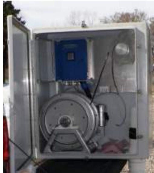
תמונה 1: יחידת ה- AutoReel עם כננת הנשלטת על ידי מחשב.
